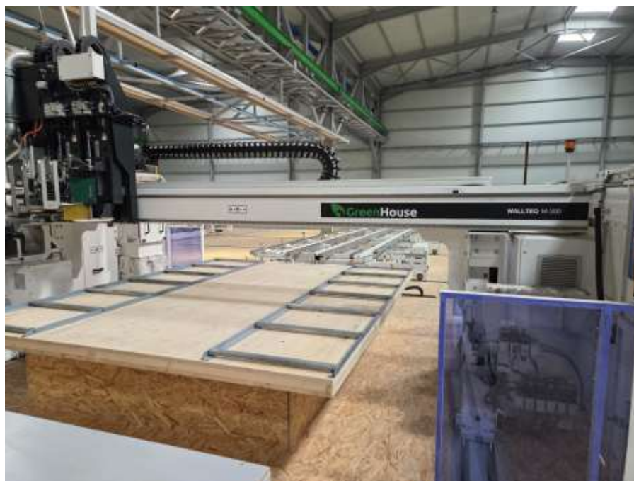
Foto 5: Detaj nga afër i makinerisë së automatizuar (modeli WALLTEQ M-300 me logon e personalizuar "GreenHouse") duke punuar mbi skeletin e një muri nga druri.
