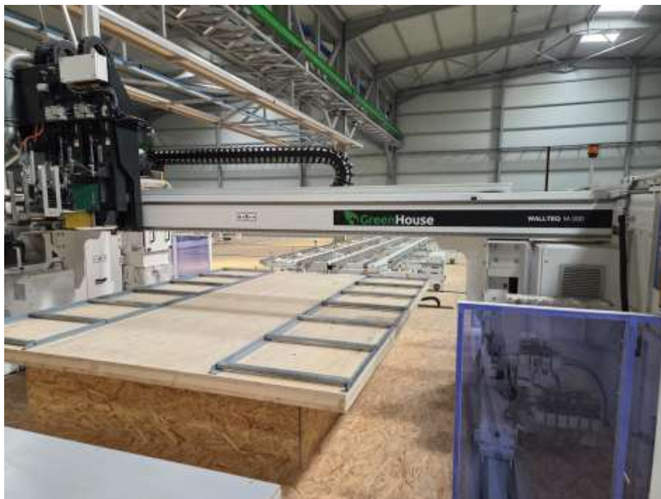
Foto 1. Detaj nga afër i makinerisë së automatizuar (modeli WALLTEQ M-300 me logon e personalizuar "GreenHouse") duke punuar mbi skeletin e një muri nga druri.
