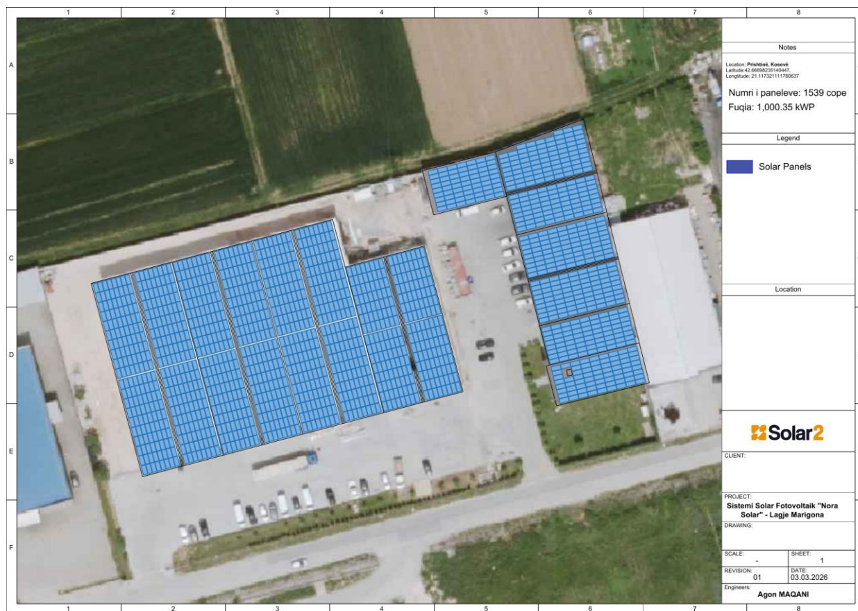
Figura 7. Shtrirja e 1,539 moduleve në kulmet ekzistuese
