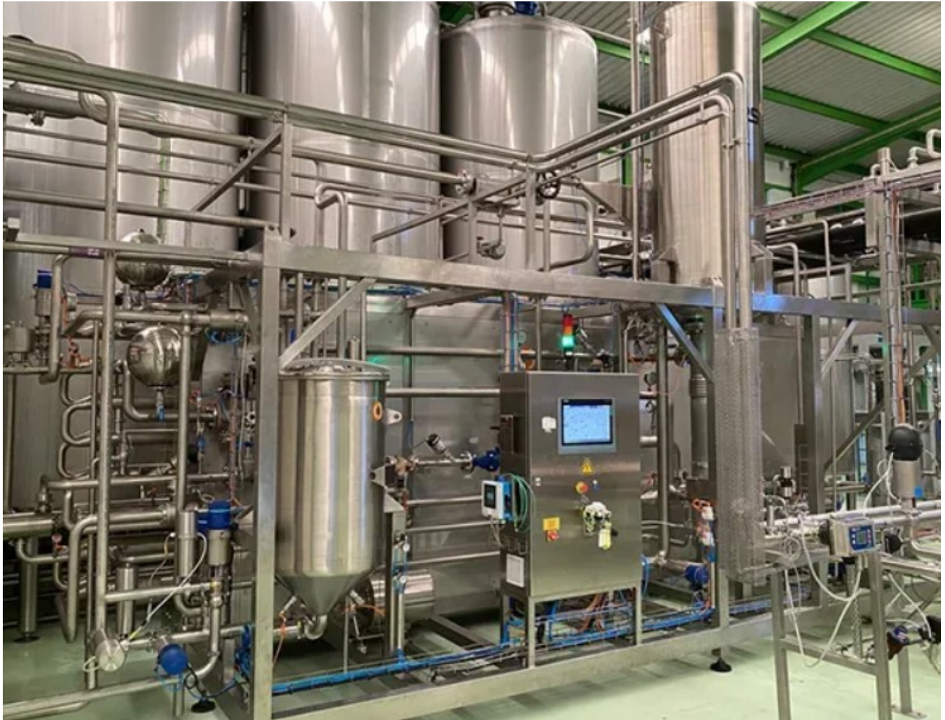
Foto 1 Makina (Pasteri) për pasterizimin e qumështit.
