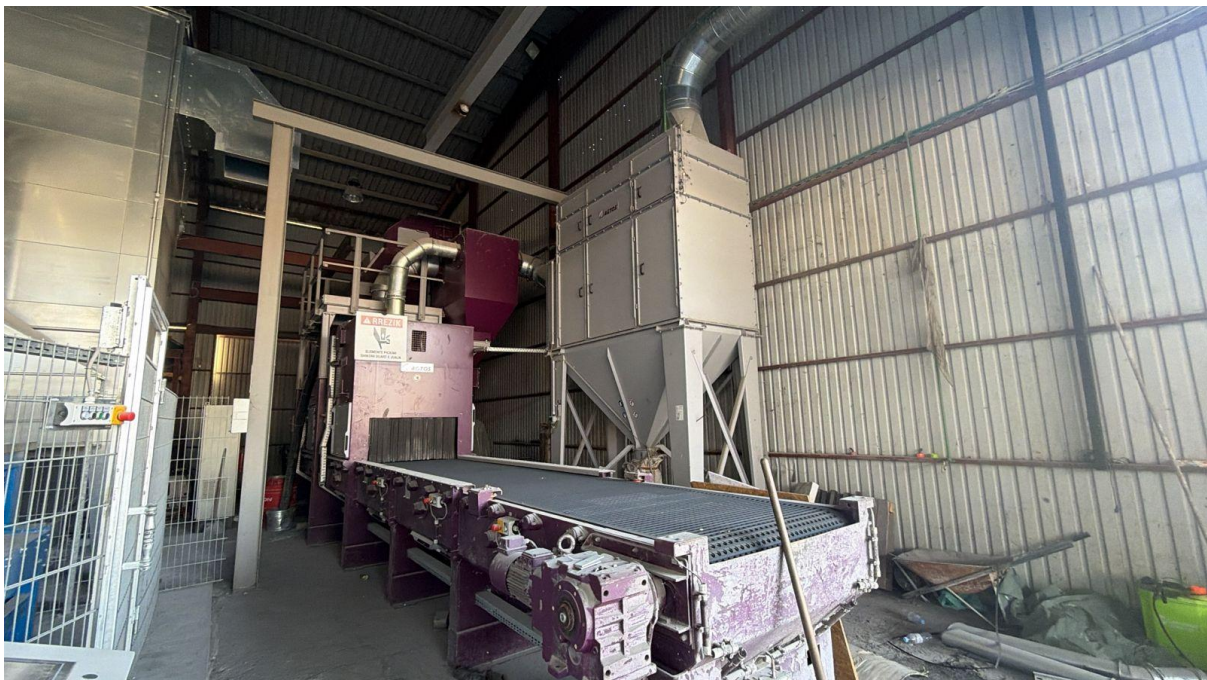
Figure 7. Makina Shot Blasting, për dekorimin e sipërm të kubezave
