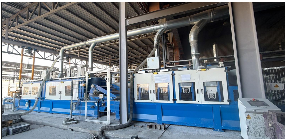
Figure 8. Makina për dekorimi e shtresës së sipërme të elementeve nga betoni
