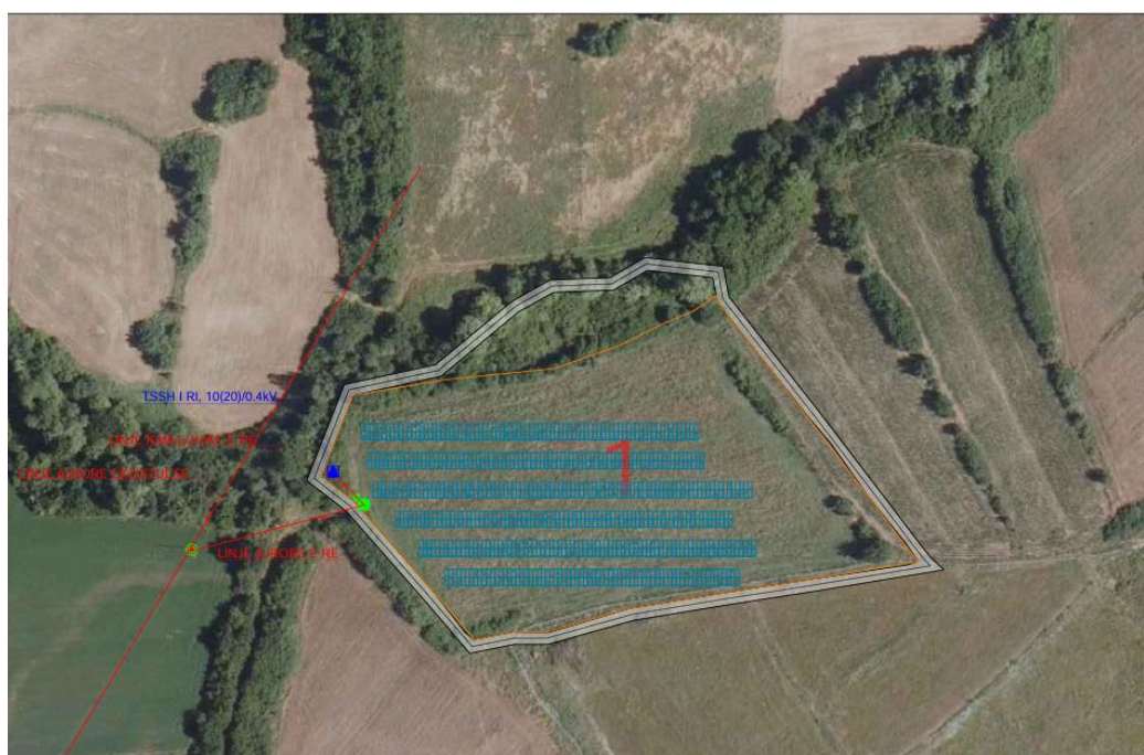
Figura 6. Plan situacioni i shtrirjes se paneleve solare.
