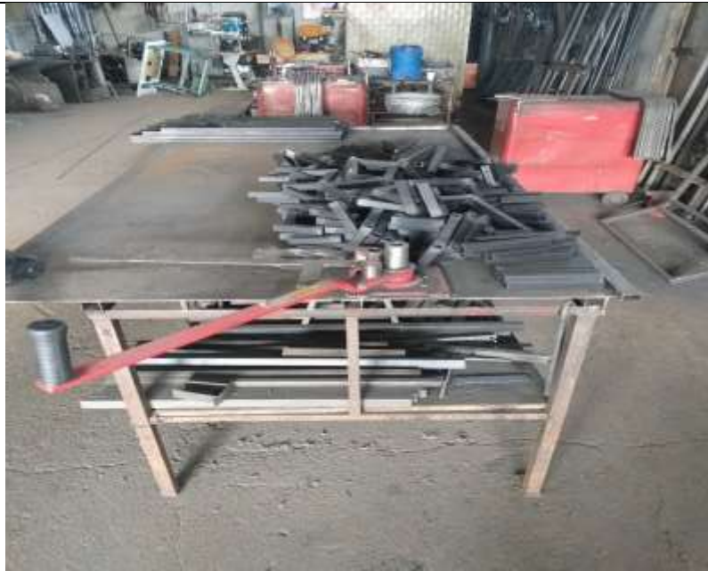
Foto 4. Përpunimi dhe dimensionimi i profileve metalike
