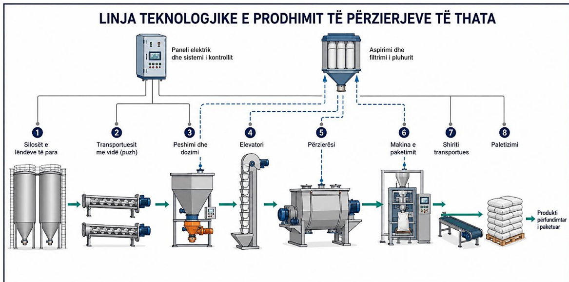
Figura 2. Skema teknologjike e linjës së përzjerjeve të thata sipas dokumentacionit të projektit
