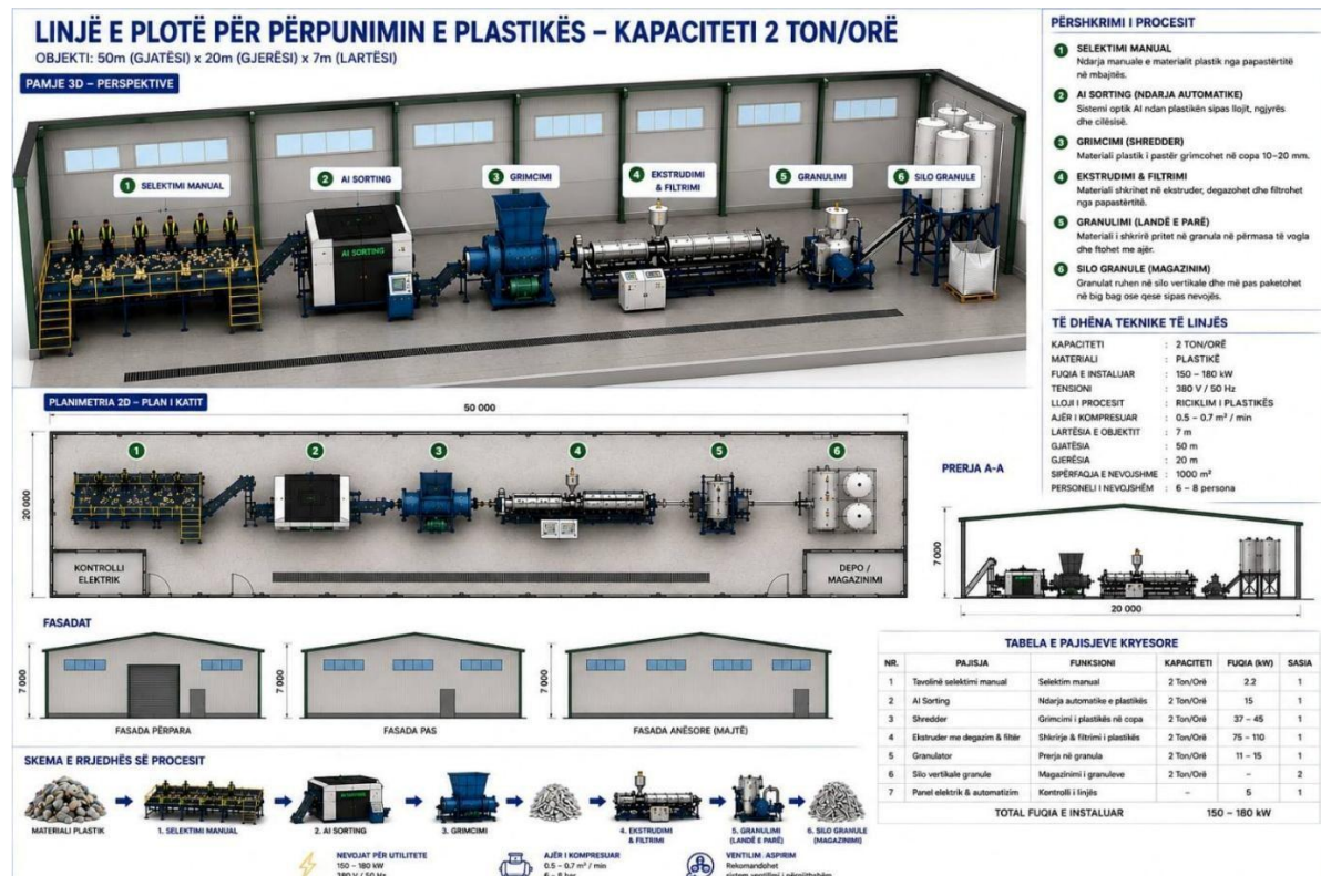
Figura 1. Skema teknologjike e përpunimit të plastikës
