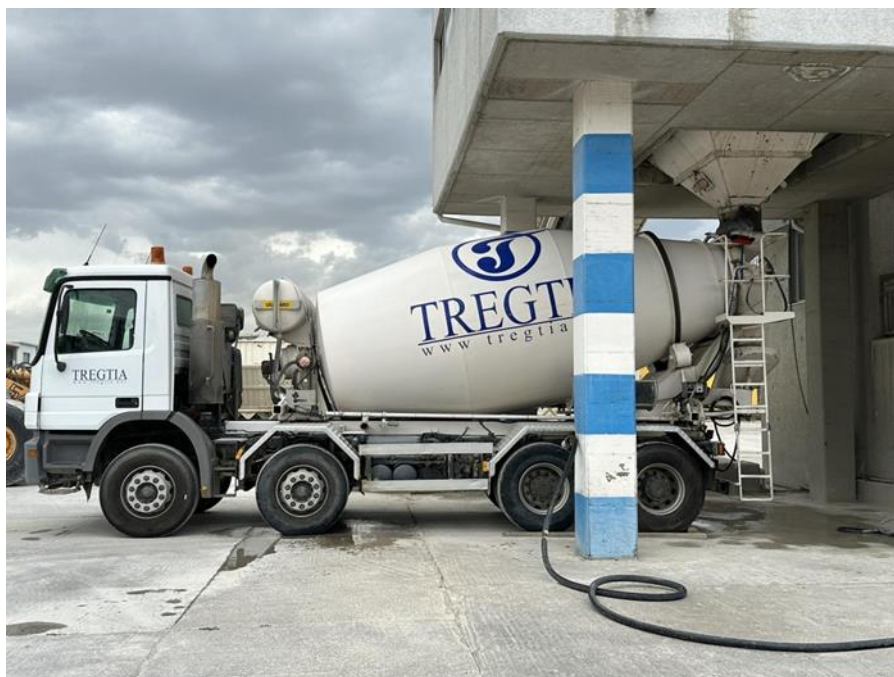
Figura 13. Auto mikserët për transportimin e betonit të prodhuar
