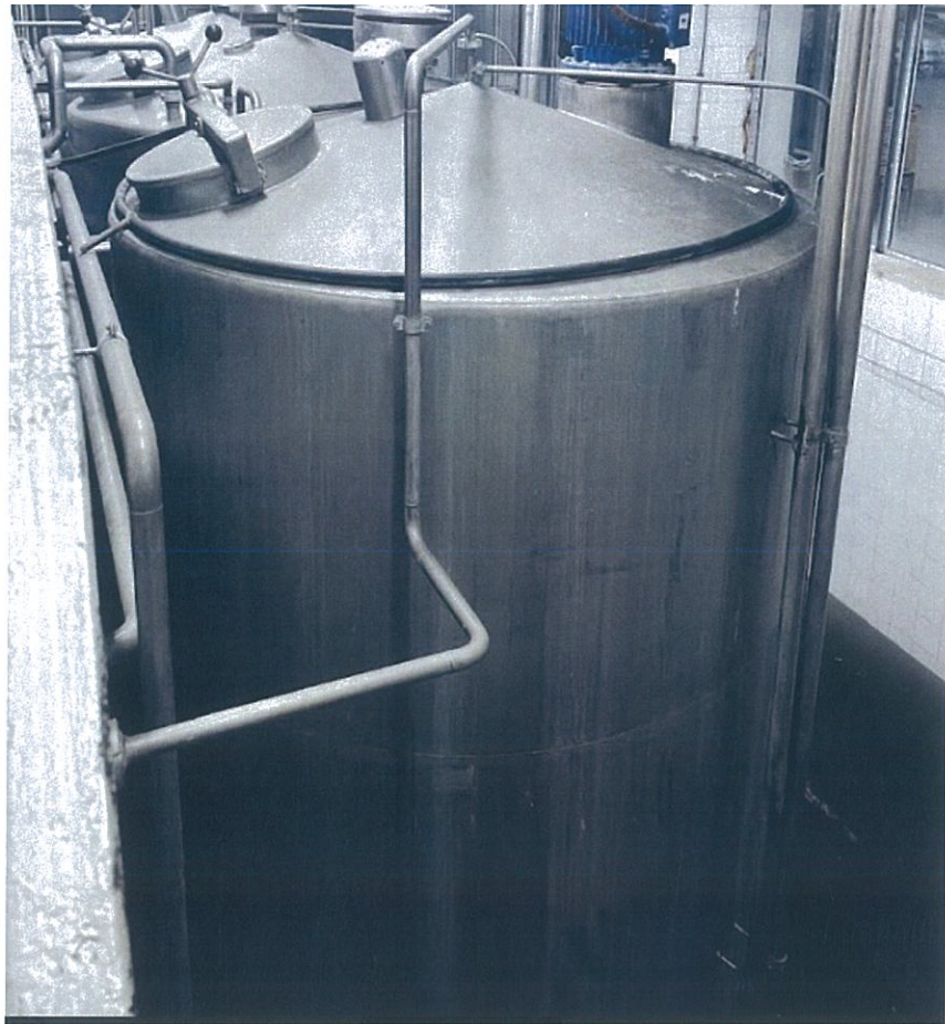
Foto-4 Rezervoarët për mbajtjen e ujit të filtruar i gatshëm për ambalazhim
