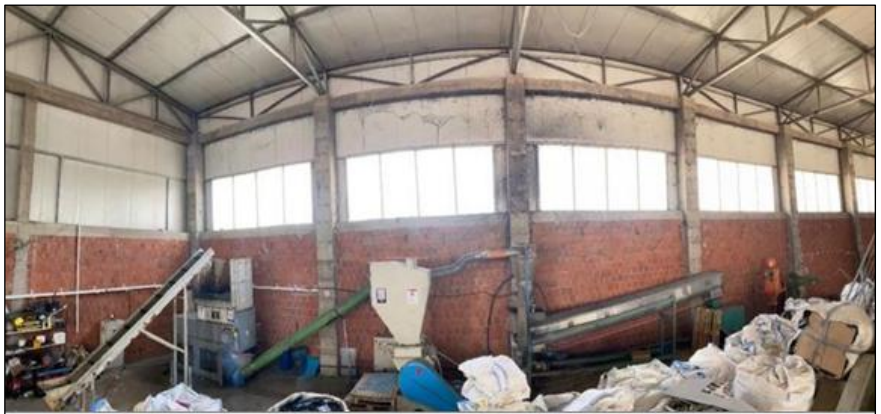
Makineria e cila përdoret për granulim dhe prodhim të folive dhe qeseve të plastikës
