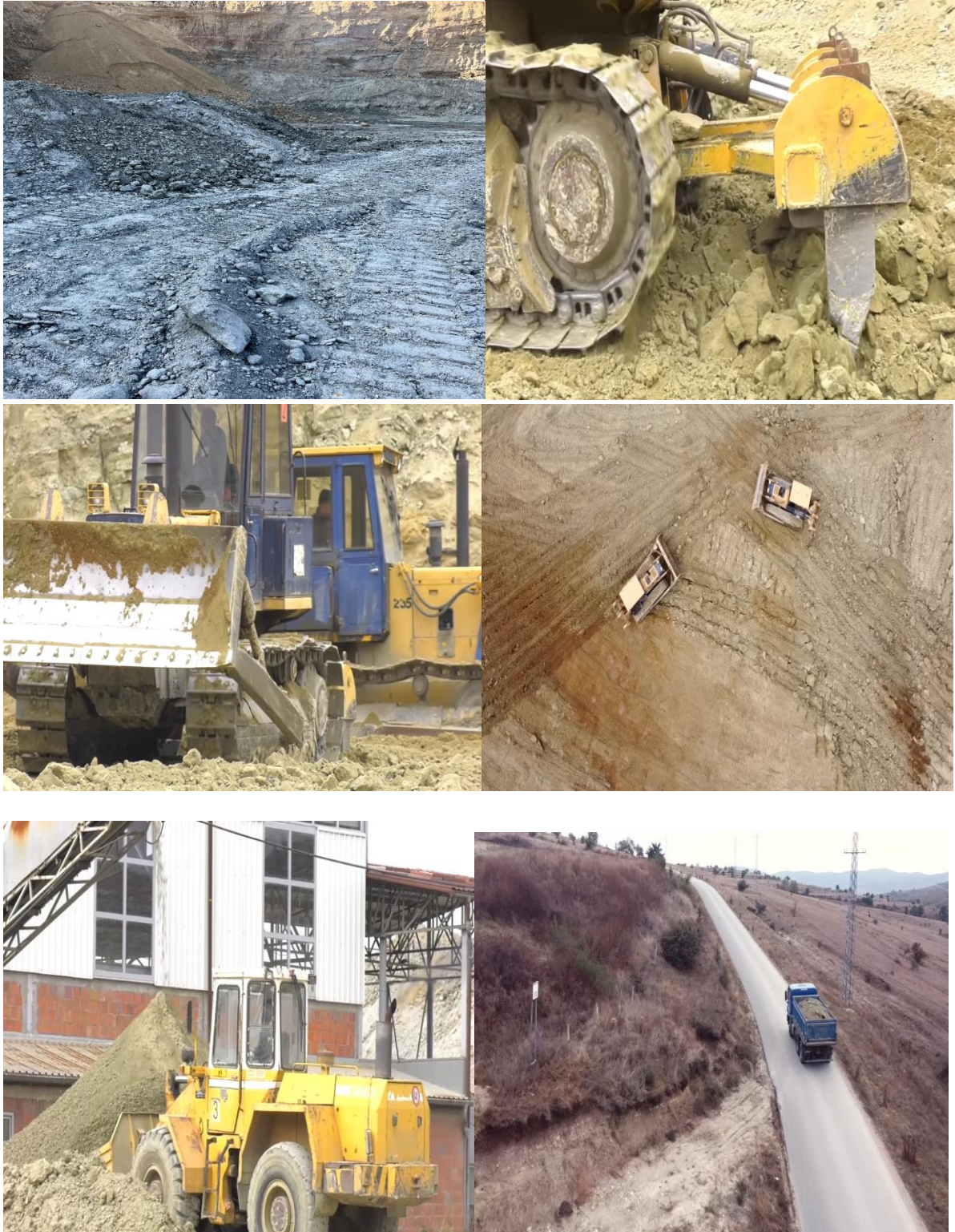
Foto 1-8. Shihet fillimi i largimit të shtresës së humusit dhe procesi i punës në tërësi deri tek deponimi dhe përpunimi i argjilës në fabrikë dhe përgatitja e procesit të punës për prodhimin e bllokave nga argjila.
