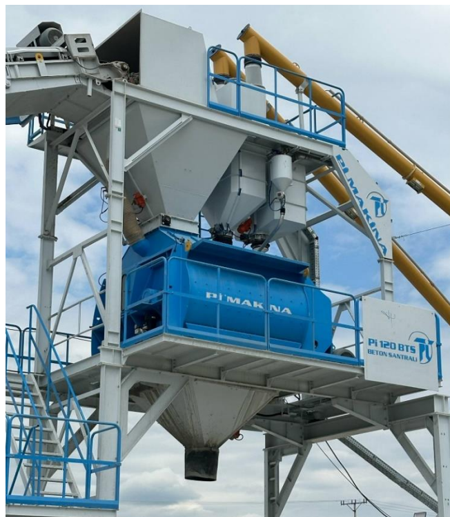
15. Përzierësja e betonit – produkti final
