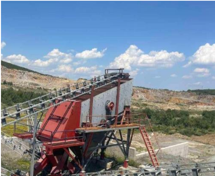
Figura 8. Sita primare vibruese tre katëshe
