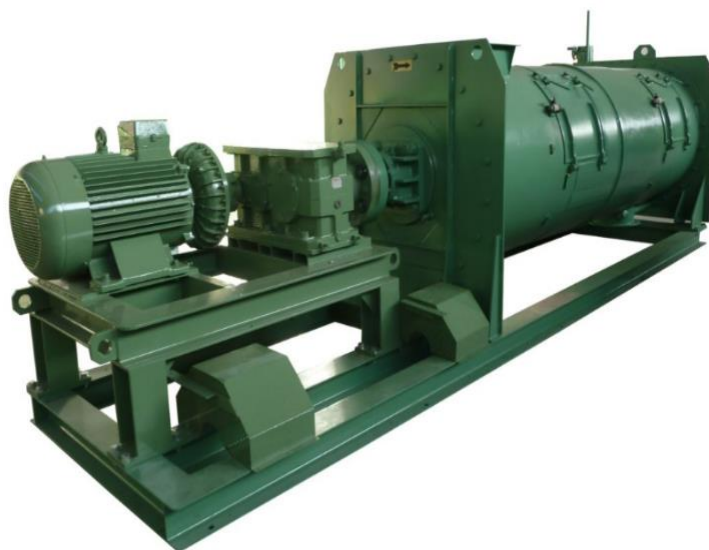
Figura 9. Mekanizmi për formësimin e gurëve të mermerizuar
