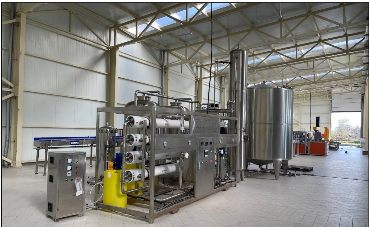
Figura 8 Makineria për pastrimin e Ujit dhe përgatitjen e tij për mbushje ne shishe (Prodhim Kinez)
