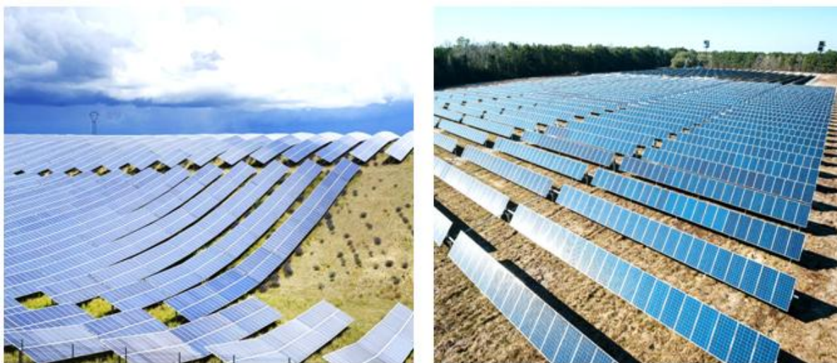
Figura 23. Vendosja e panelave Fiks dhe Sistem me një aks.
