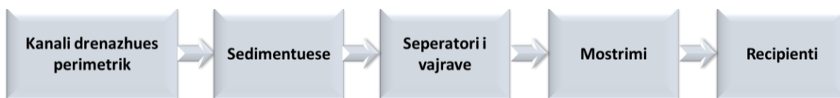
Fig 5. Skema teknologjike e trajtimit të ujërave
