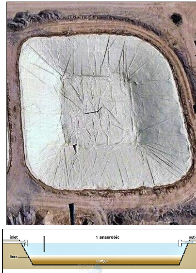
Figura 8 Model i lagunes e cila do ti trajtoj ujerat nga pastrimi dhe reshjet atmosferike
