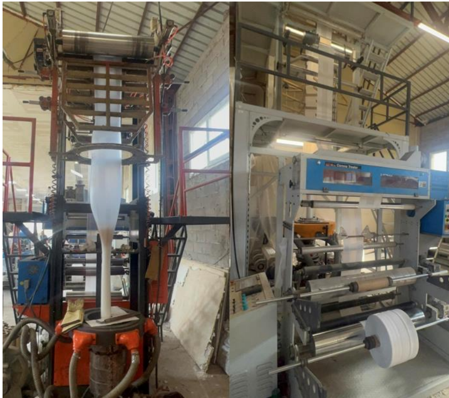
Figura 20. Foto procesi i formimit te qeseve.
