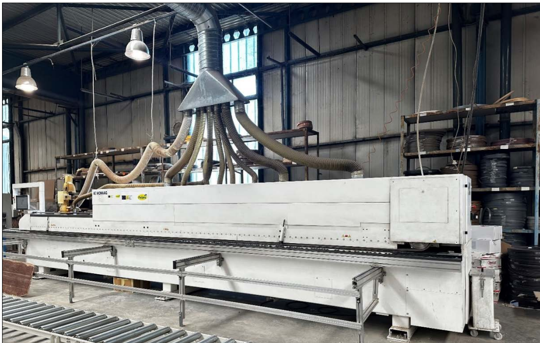
Figura 7. Makineria ABS për ngjitjen e ngjitësit
