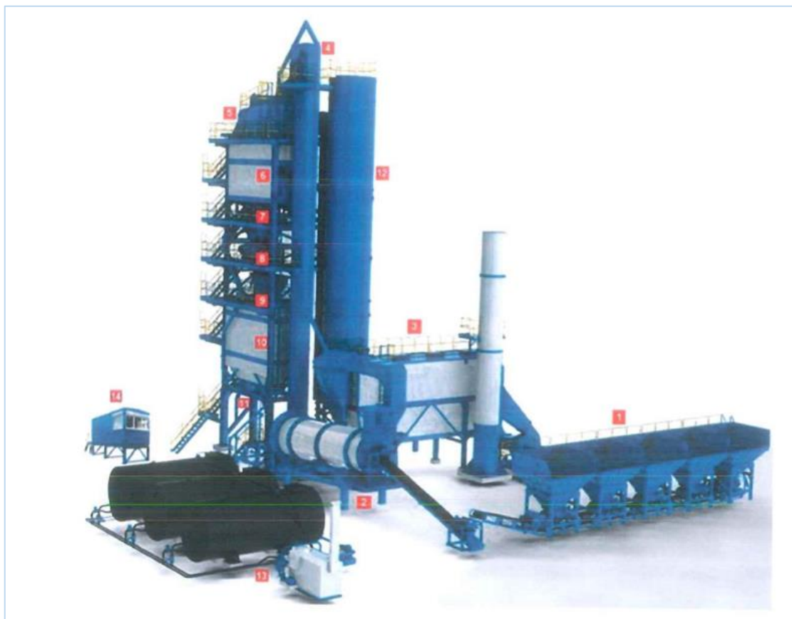
Figura 14. Skema parimore e bazës së asfaltit me veprim ciklik
