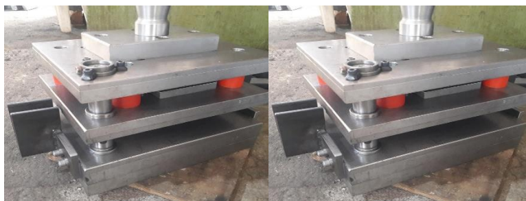
Figura 18. Vegël për Prese-Shtance për prodhimin e Distancerave për CD Distancerë-Straight.
