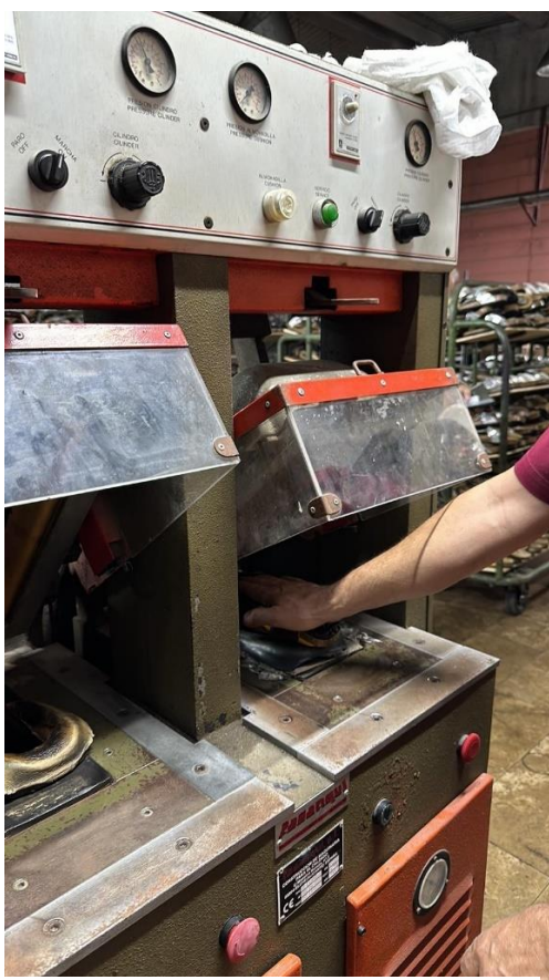
Figura 10. Qepja e Tabanit te kepuces
