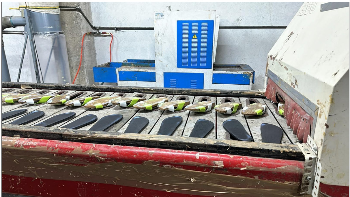
Figura 12. Montimi i Tabanit me Pjesën e Sipërme
