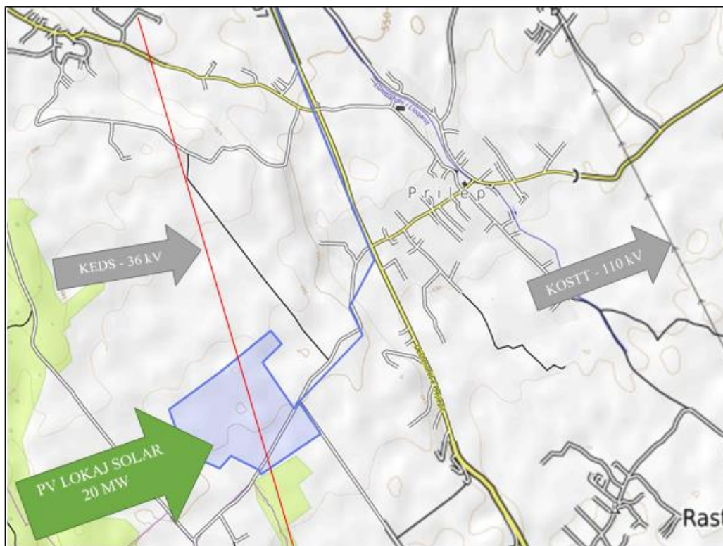
Figura 2. Kyqja e impiantit në linjën transmetimi 110 kV
